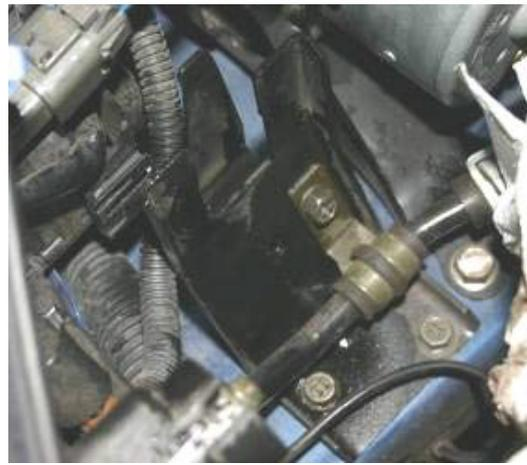
純正タンクをステアから取り外したら、純正パワーステアタンクから、ホースを取り外す作業を行います。ホース取り外しの際にタンク内部・ホース内部のフルードがあふれ出しますので、ウエス等でベルト・車体を養生してください。
