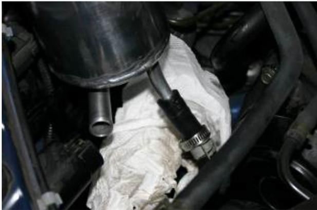
本製品を取り付けます。まず純正ホースとPSタンクを接続します。このとき、取付バンドを写真のように通しておくことを忘れないで下さい。φ11ホース・φ15ホース共にできるだけ奥までホースを差し込んで下さい。
