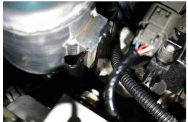
PSタンクは、純正タンク同様、純正のステアへはめ込み式で固定できるように設計されておりますので、純正を取り外した手順と同様に取付けて下さい。
