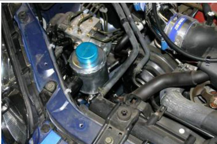
写真のような形で取付が完了します。1時間程度走行後、車体を止め、エンジンを停止させ、フルードの残量をチェックしてください。足りない場合は、補充し、多い場合は抜き取ってください。また、純正エアクリーナの場合は、純正インテークダクトを取り付けてください。
