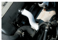
ブローパイプ
