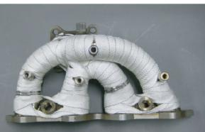
※必ず乾燥工程を行って下さい。完全に乾燥していない状態で車両への取付け、エンジン点火を行いますと、車両火災の発生や、発煙ガスの吸い込みにより作業者の気分が悪くなる等、重大な事故に発展する可能性がございます。
