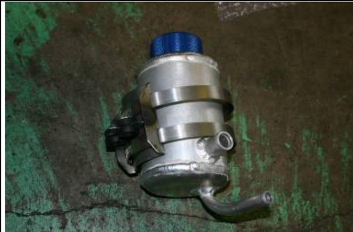
専用のステアを写真のようにPSタンクに装着します。このとき、バンドは締め込まずに、本体を車体に合わせて、ステア位置を決定してから、締め込んでください。
