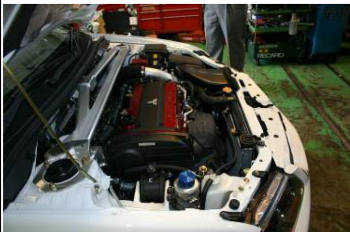
写真のような形で取付が完了します。1時間程度走行後、車体を止め、エンジンを停止させ、フルードの残量をチェックしてください。足りない場合は、補充し、多い場合は抜き取ってください。
