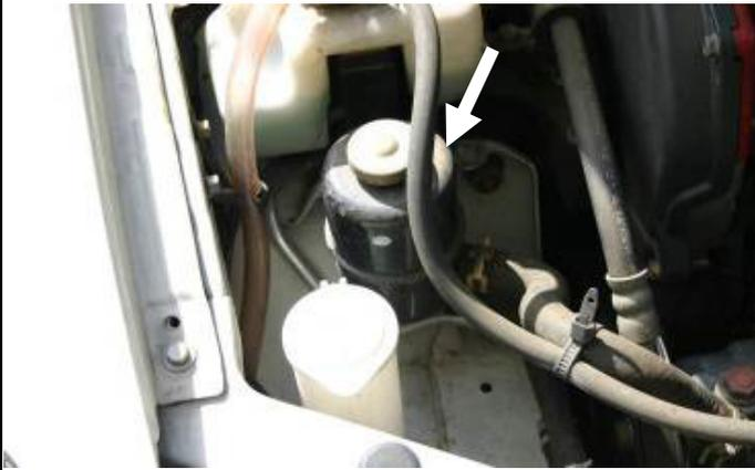
純正のタンク位置を確認します。ボンネットを開けて運転席側ヘッドライト後に上記写真のようなタンクが装着されています。ボルトにて取り付けられていますので、ボルトを取り外し、タンクを取り外してください。
