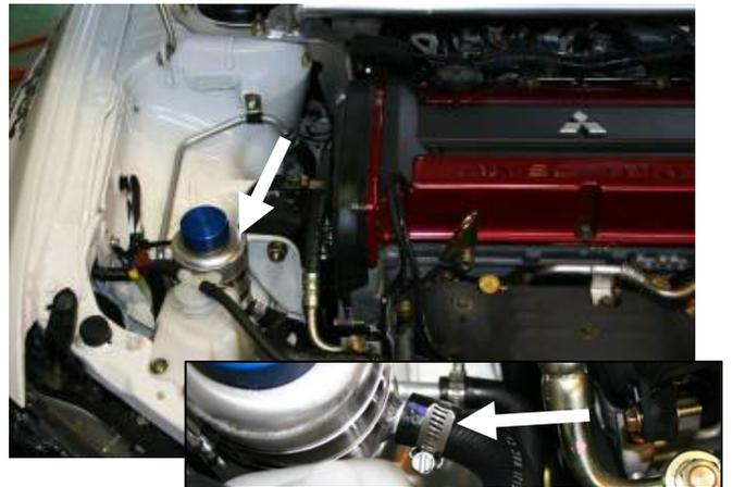
本製品を取り付けます。まず純正ホースとPSタンクを接続します。このとき、取付バンドを写真のように通しておくことを忘れないで下さい。Φ11ホース・Φ15ホース共にできるだけ奥までホースを差し込んで、付属のホースバンドで、しっかりと締めてください。
