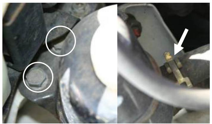
純正タンクを車体から取り外します。ボルトで車体と固定されているので、ボルトを取り外します。次は純正パワステタンクから、ホースを取り外す作業を行います。ホース取り外しの際にタンク内部・ホース内部のフルードがあふれ出しますので、ウエス等でベルト・車体を養生してください。
