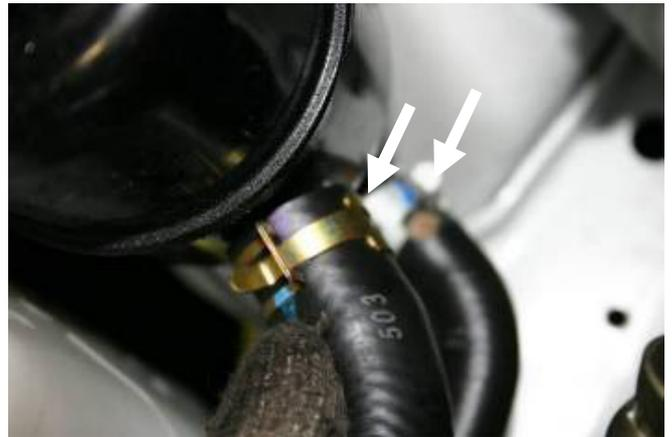
純正タンクをステアから取り外したら、純正パワーステアリングから、ホースを取り外す作業を行います。ホース取り外しの際にタンク内部・ホース内部のフルードがあふれ出しますので、ウエス等でベルト・車体を養生してください。
