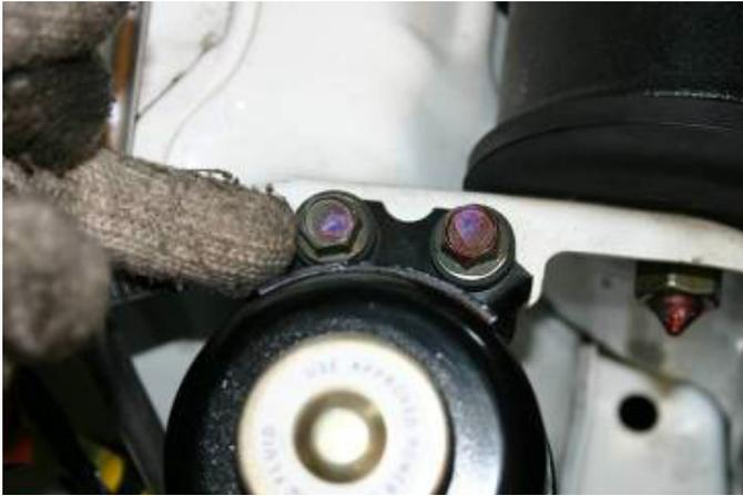
純正のタンク位置を確認します。ボンネットを開けて運転席側ヘッドライト後に上記写真のようなタンクが装着されています。ボルトにて取り付けられていますので、ボルトを取り外し、タンクを取り外してください。
