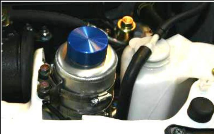
純正ボルトを締め込んで写真のような形で取付が完了します。1時間程度走行後、車体を止め、エンジンを停止させ、フルードの残量をチェックしてください。足りない場合は、補充し、多い場合は抜き取ってください。
