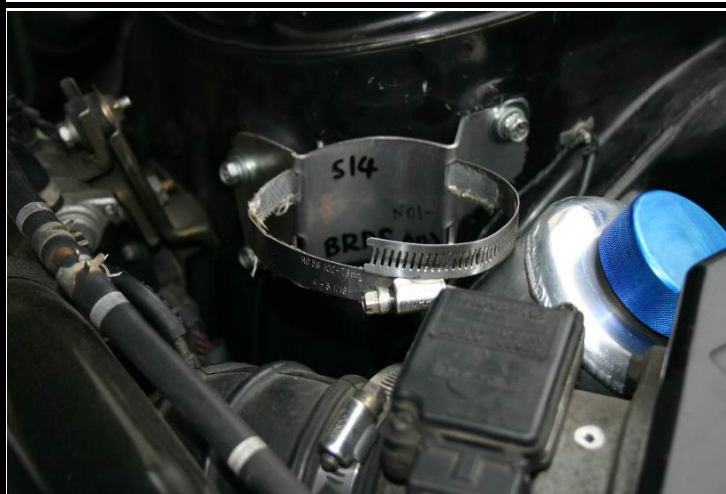
④PSタンク本体固定用のバンドの取付
