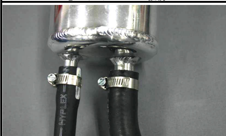
⑤PSタンクとホースの接続
