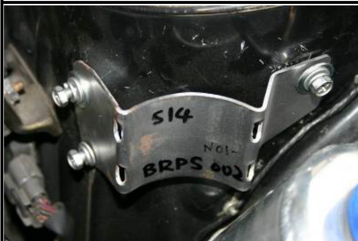
③PSタンク専用スターの取付
