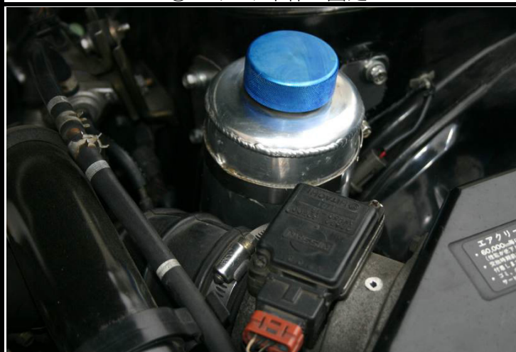
⑥PSタンク本体の固定
