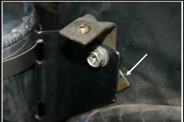
プラスチックタンクの取付ステア(写真のパーツ)は若干の加工が必要です。写真の矢印部分は、純正状態ですと曲がっています。これを、万力等で、写真のように、引き伸ばす必要があります。
