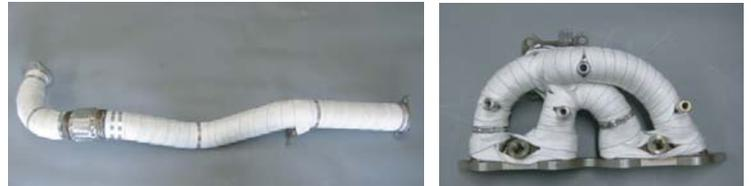
**※必ず乾燥工程を行って下さい。完全に乾燥していない状態で車両への取付け、エンジン点火を行いますと、車両火災の発生や、発煙ガスの吸い込みにより作業者の気分が悪くなる等、重大な事故に発展する可能性があります。絶対に未乾燥の状態で作業を行わないで下さい。**
